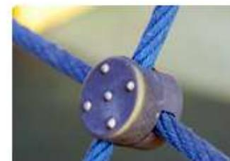
**Cordaje:**  $\varnothing 16$  mm. polipropileno 6 cables trenzados armados de 42 briznas de acero inoxidable con sistemas de fijación que suprimen todo riesgo de atrancamientos de dedos.
