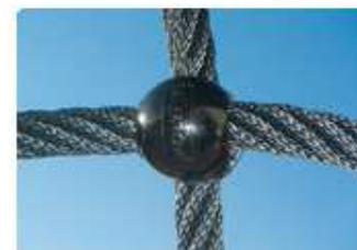
**Cordaje:**  $\varnothing$  16 mm formado de 6 cables trenzados de acero galvanizado recubierto con multifilamentos en polipropileno tratados contra el U.V.
