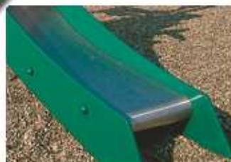
**Rampas deslizantes de tobogán:** monobloque sin soldaduras y en acero inoxidable 18-10 (304L) de espesor 2mm, acabado "pulido", y con película protectora.
